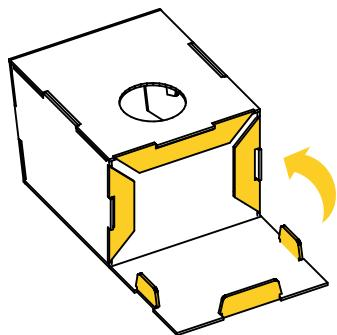
**9** Una vez montadas las dos piezas, levanta las dos pestañas circulares de la pieza A y encájalas dentro del agujero de la pieza B.
