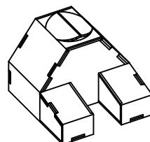
**6** Pieza B. Comenzar plegando hacia arriba los laterales y encajando las pestañas con las ranuras correspondientes, dejando siempre las solapas hacia el interior.
