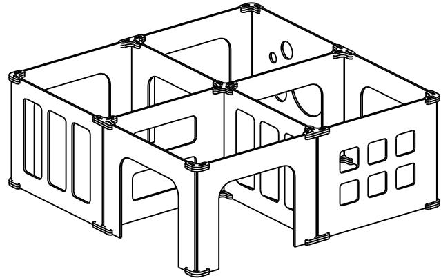
**5** Montamos el detalle de almenas insertando las llaves de unión.
