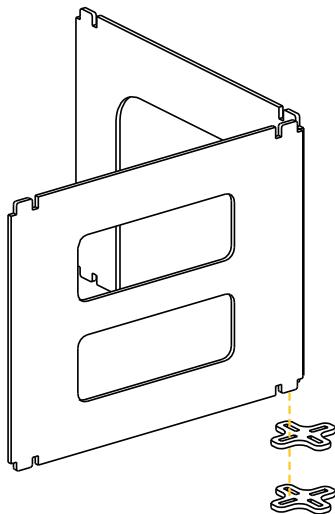
**2** Completamos la unión de las dos paredes cerrando con dos piezas de unión por la parte superior.
