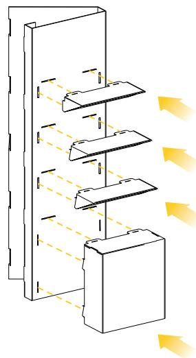
**5** Completamos el módulo cerrando la parte trasera de la pieza **A**.
