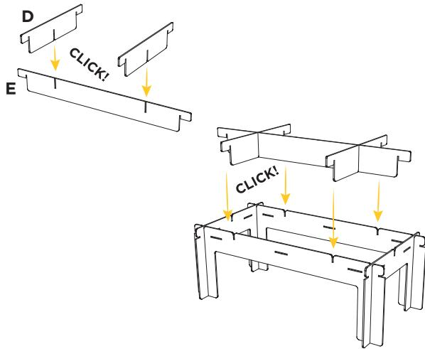
**3** Montar el tablero de la mesa. Doblar la pieza en torno a la estructura inferior. Las pestañas de la pieza A deben encajar en las ranuras de las patas.
