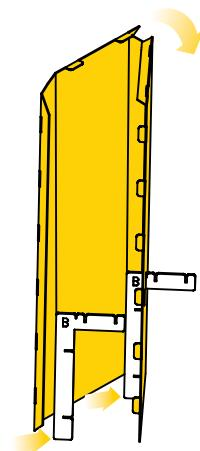
**3** Colocar la pieza **F** sobre la estructura, abrazandola y encajando las pestañas exteriores en su correspondiente ranura interior.
