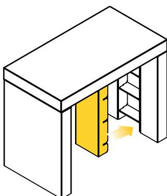
**1** Colocar las dos piezas **A** enfrentadas y unir con las costillas **B** por los laterales y **C** (marcada con una X) por arriba.
