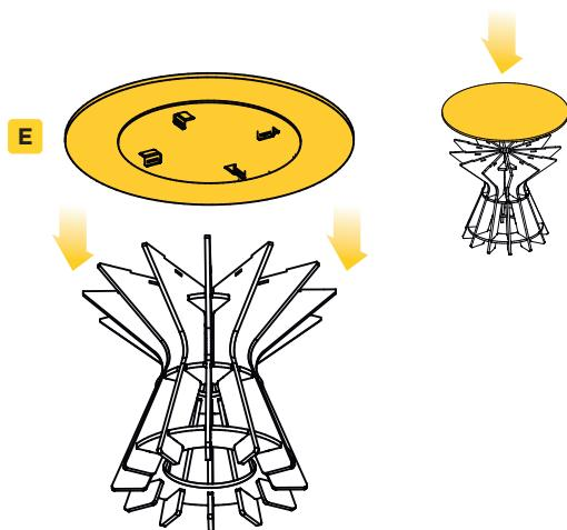
**5** Por último, asegurar el tablero a la estructura de patas haciendo coincidir las ranuras del tablero, con 4 ranuras de las patas. Asegurar con pasadores **F** (Ver detalle 1).
