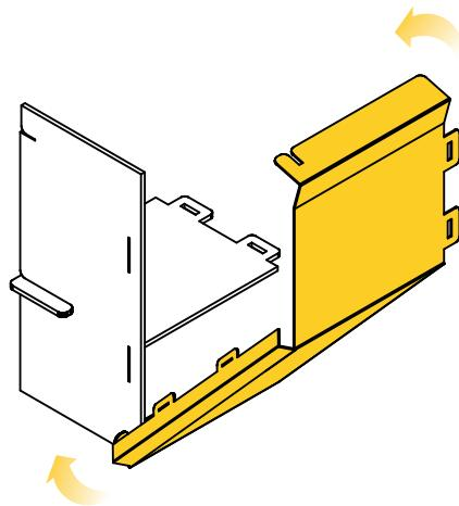
**6** Coloca el mostrador en sus ranuras correspondientes en la pieza **B** y asegurar con cuatro piezas **D**.
