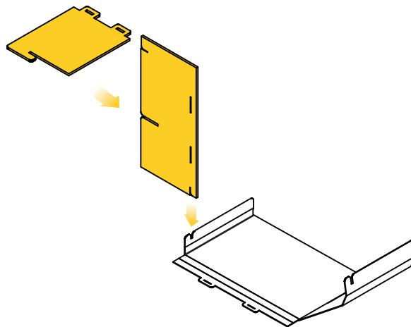
**5** Introduce dos piezas **D** asegurando la unión de **F** con **E**
