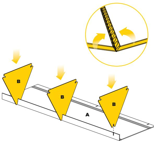
**2** Girar las piezas **B** para encajar en las ranuras del otro extremo de la pieza **A**.
