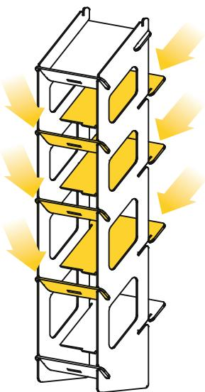
**4** Insertar la pieza **D** sobre la parte superior de la pieza **A**.
