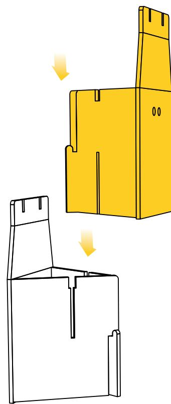
**3** Doblar las partes superiores de las piezas e introducirlas en la ranura central.
