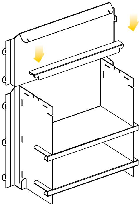
**4** Para completar el montaje, cerramos las solapas laterales de la pieza **A** y colcoamos las llaves de seguridad desde el interior.
