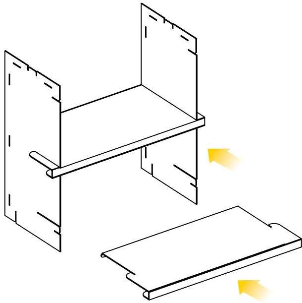
**2** Con la pieza **A** predoblada tal y como se indica en el detalle encajamos sus ranuras en la parte inferior de **D**.
